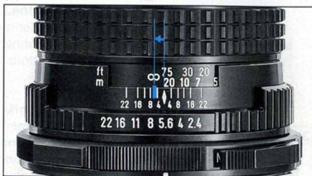
Come mostrato in fig. 1, effettuate una messa a fuoco normale, e leggete la distanza sull'obiettivo. Quindi (fig. 2) ruotate l'anello di messa a fuoco finché il valore numerico della distanza rilevata in precedenza corrisponde all'indice per l'infrarosso. Nell'esempio delle fotografie sopra, il valore di messa a fuoco rilevata corrisponde a infinito ( $\infty$ ).
