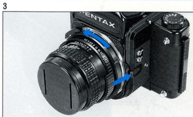
3. Per smontare l'obiettivo dalla fotocamera, ruotatelo in senso antiorario premendo contemporaneamente la leva di sblocco sul corpo camera.
