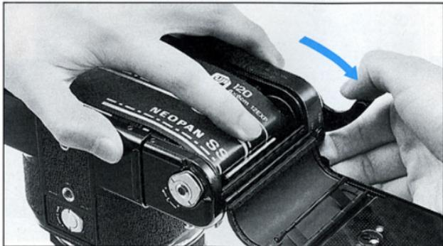
6. Esercitando una leggera pressione sulla carta, come nell'illustrazione, ruotate la leva di avanzamento finché la bobina effettua un giro completo.
