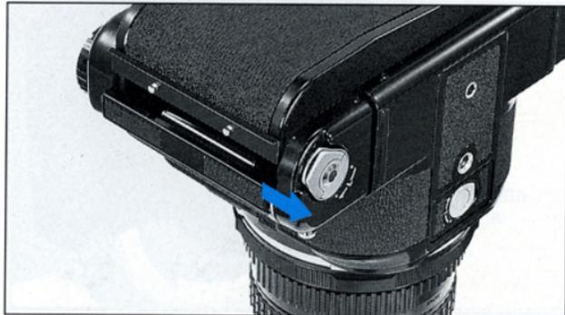
Il meccanismo dell'otturatore della Pentax 67 è stato progettato in modo da essere disinnestato quando l'apparecchio è privo di pellicola. Nel caso doveste far scattare l'otturatore senza caricare il film, seguite uno dei due metodi seguenti.
