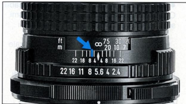
Fotografando con pellicola per infrarosso con filtro R2 o O2, è necessario effettuare una compensazione della messa a fuoco in quanto luce visibile e luce infrarossa hanno piani di messa a fuoco differenti.
